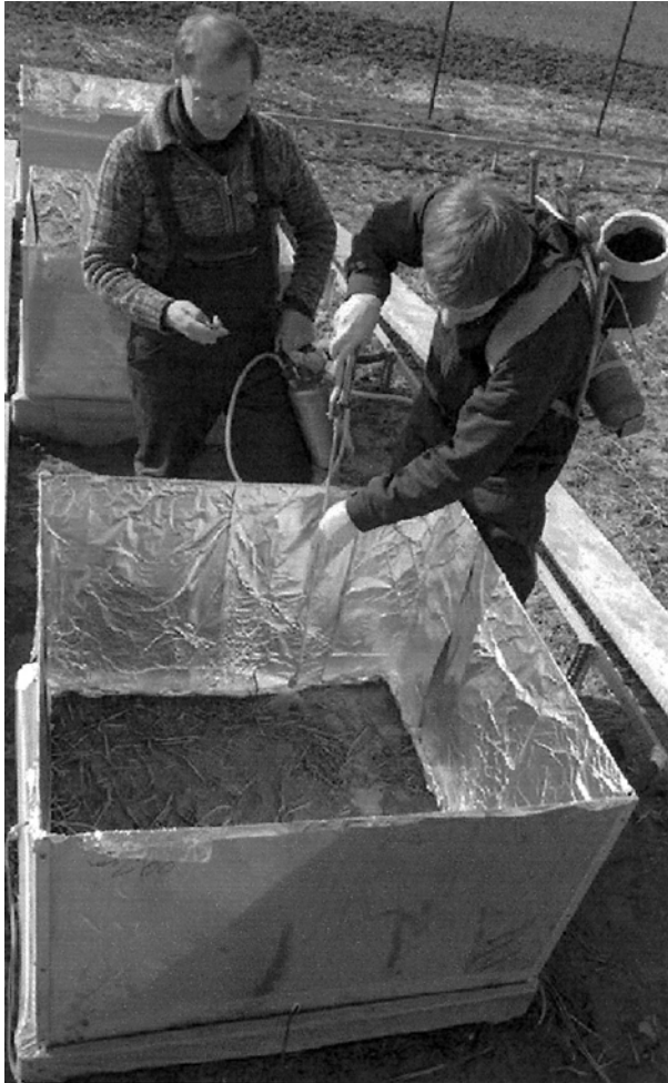
Fig. 8.3: Druckluftgetriebene Spritzapplikation eines 1,0 m 2 -Lysimeters mit Aluminiumfolie ausgekleidetem Kontaminationsschutz. Compressed air driven spray application of a 1.0 m 2 -lysimeter with contamination protection covered with aluminium foil.
