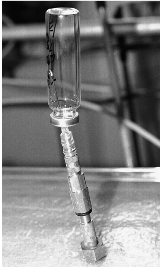
Fig. 12.7: Luftlanze mit Kapillare und angeschlossenem, heliumgefüllten Sammelgefäß. Air lance with capillary attached to a helium-filled collecting vessel.
