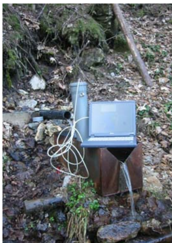
Abflussmessstation mit Datensammler
